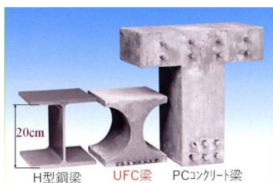
曲げ荷重150kNmに耐え得る梁の断面イメージ
