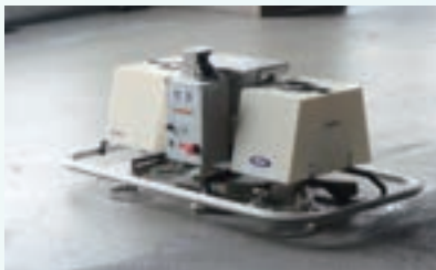
コンクリート床仕上げロボット (T-iROBO® Slab Finisher)
