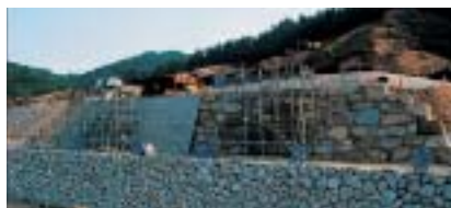
「穴太衆積み」の伝統を受け継ぐ、14代目栗田純司さんたちの手によって石組みが組まれた。写真は現地での「穴太衆積み」とコンクリートブロックの載荷実験
