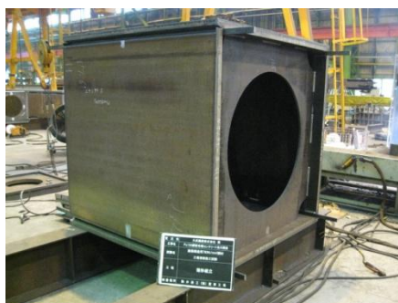
写真-9 実大溶接施工試験の試験体 Photo.9 Factory weld construction test piece
