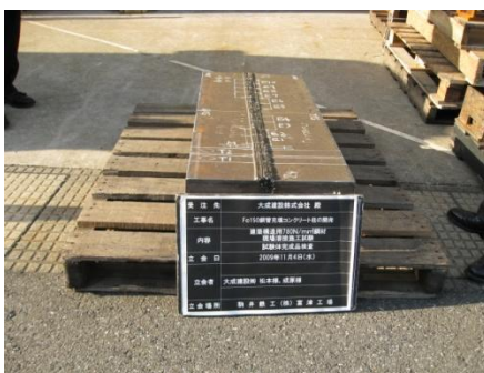
写真-10 現場溶接接合施工試験の試験体 Photo.10 Site weld construction test piece
