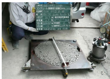
写真-5 受入れ検査の一例 (スランプフロー72.5cm) Photo.5 Example of receiving inspection (slump flow 72.5cm)
