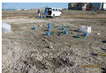
微動チェーンアレーの受振器配置状況
