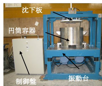
図-1 締固め試験装置
