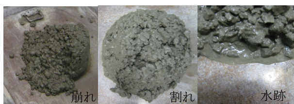
図-5 叩き試験後分離の一例
