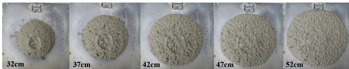
図-6 叩き試験による試料上面の円形変化状態（標準配合）
