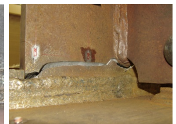
(d) フランジ破断[GL-20]
