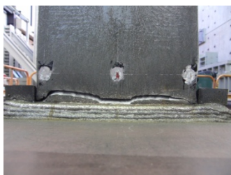
(a) フランジ破断[K-20]
