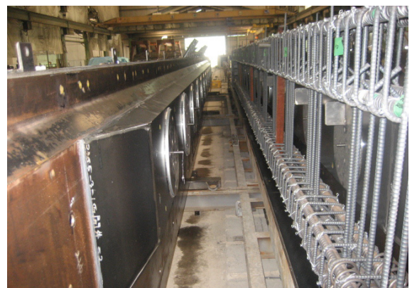
写真-2 PCaPC 梁(T-POP) の製作状況 Photo 2 Fabrication of PCa PC beam (T-POP)
