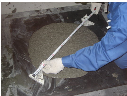
写真-1 コンクリートのフロー状況 Photo 1 Slump flow of concrete
