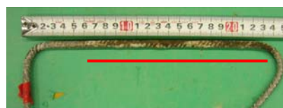
写真-5 せん断補強鉄筋の腐食状況
