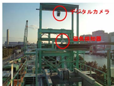
図-18 ベルト接合部監視システム設置状況 Fig.18 Installation situation
