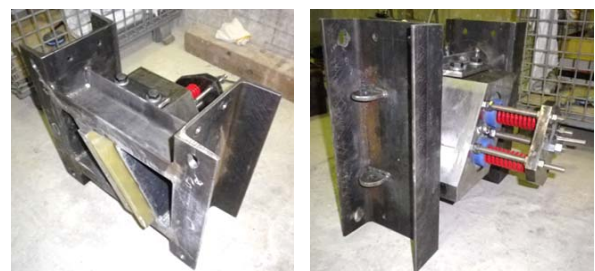
図-15 スクレーパー全景（左：地山側、右：坑内側）
