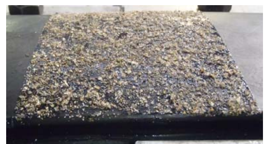
図-8 ゴムブロックへの砂付け状況 Fig.8 Pasting sand with starch glue on the rubber block
