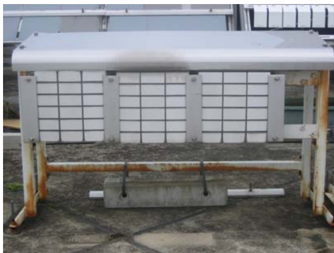
写真-1 タイル試験体1の暴露状況 Photo1 Outdoor exposure test of ceramic tiles (Test piece 1)
