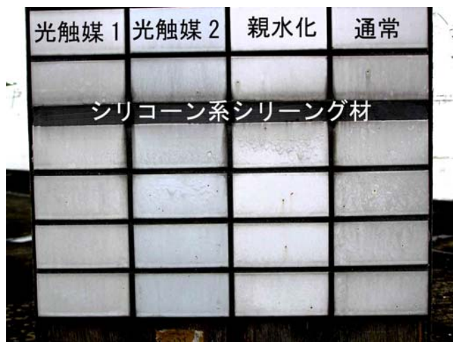
写真-5 北面のシリコン系シーリング材下部の状態(試験体2)
