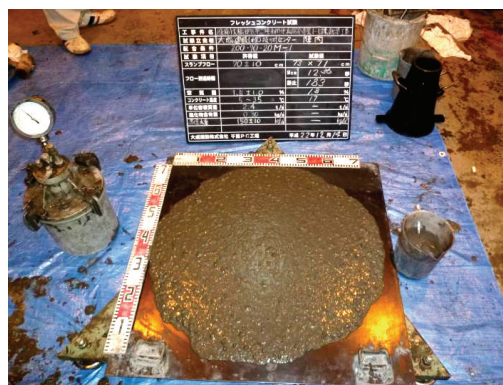
写真-2 フレッシュ試験の状況 Photo 2 Fresh concrete tests
