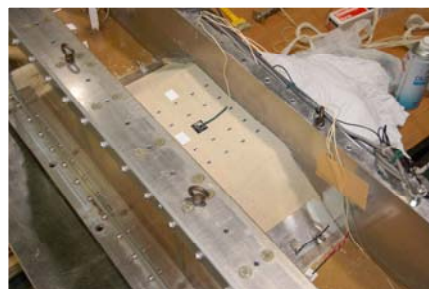
Case-8 (盛土高 H=2.4\text{m} , 改良体位置: 天端直下)
