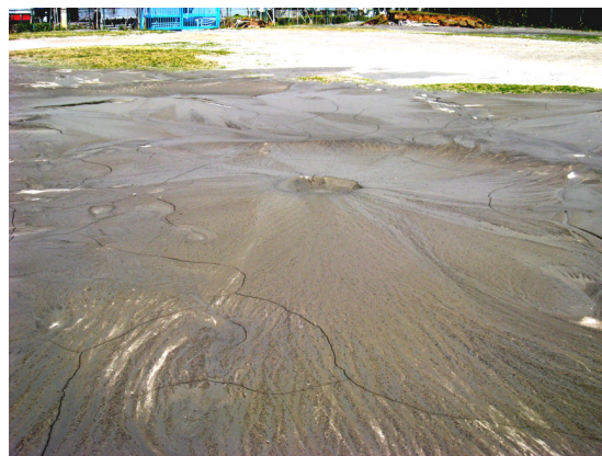
写真－1 新木場地区における噴砂 Photo 1 Sand boils in Shinkiba
