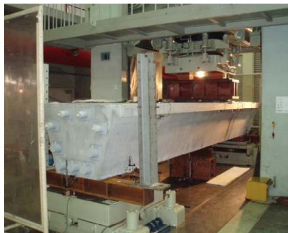
写真－3 縮小梁モデル载荷実験状況 Photo 3 Loading test of UFC wet joint
