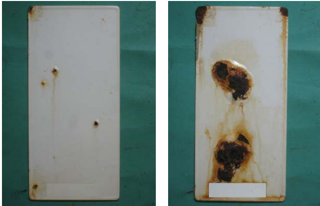
写真-2 最終サイクル後の状況 (左: S1, 右: S3) Picture 2 Last condition of test piece
