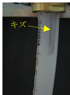
写真-1 止水部をまたぐ傷による漏水 Photo.1 Leakage of wound over packing.
