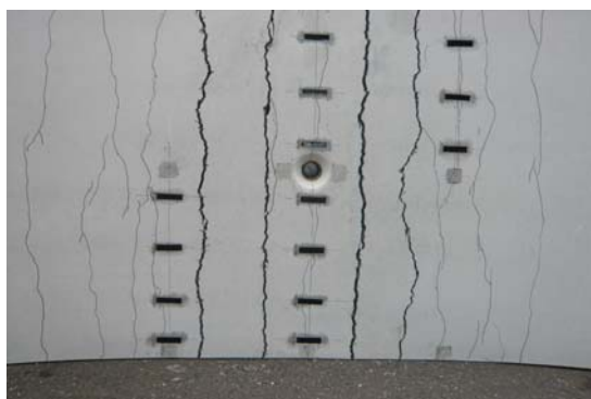
図-14 等曲げ区間ひび割れ発生状況（線載荷終了時） Fig.14 Crack patterns of section of uniform bending moment
