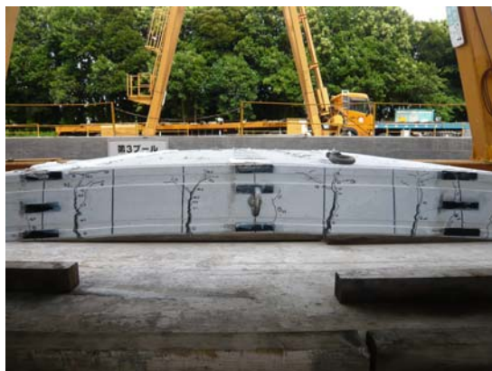
図-14 等曲げ区間ひび割れ発生状況（線載荷終了時） Fig.14 Crack patterns of section of uniform bending moment
