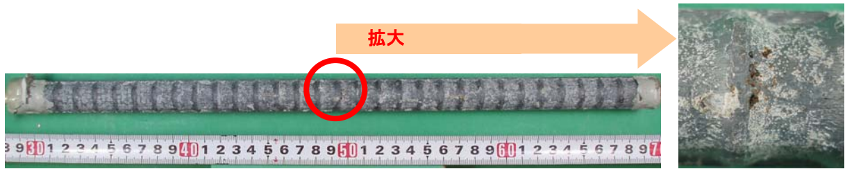
写真-2 腐食発生状況 (供試体 No. 45N-2)
