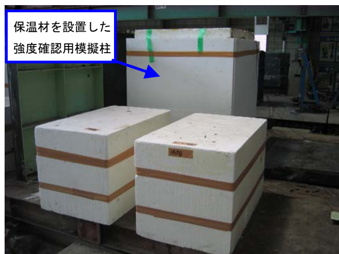
写真-3 強度確認用模擬柱の保温材設置状況
