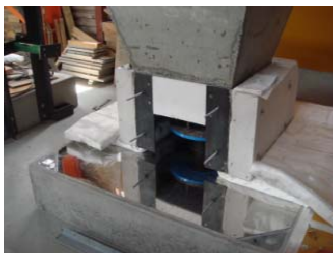
写真-1 弾性すべり支承用耐火被覆システム分解時の様子 Photo.1 Fire protection system for elastic sliding bearing
