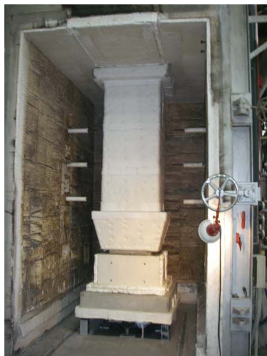
写真-3 試験体設置状況 (載荷加熱試験) Photo.3 Loading fire test setup.
