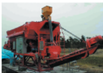
現地混練システム
