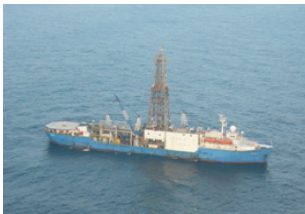
写真-7 基礎試錐で使用した米国海底掘削船 ジョイデスリソリューション号 Seafloor Drilling Ship, JOIDES Resolution, Used for Fundamental Drilling Experiment
