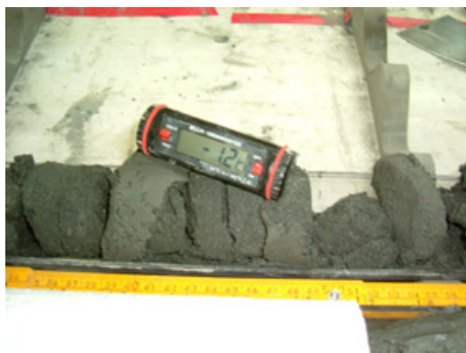
写真-9 メタンハイドレートが含まれる回収コア試料 Recovered Core Sample Including Methane Hydrate
