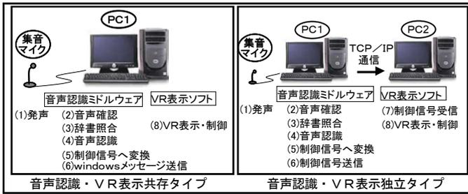
図-1 音声認識機能の概要 (イメージ)
