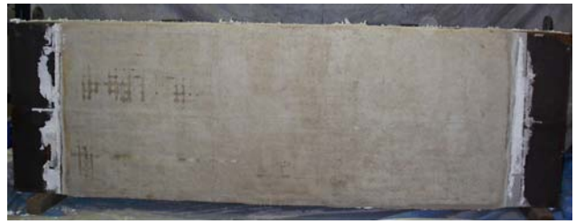
写真-4 耐火被覆付コンクリート充填鋼殻試験体(CFSS1) 加熱面状況 Post-heating surface of concrete filled steel shell specimen with fire resistant materials
