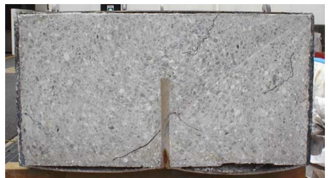
写真-7 無被覆コンクリート充填鋼殻試験体(CFSS2)切断面状況 A cross section of concrete filled steel shell specimen after heating
