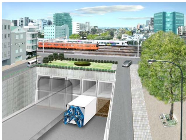
図-1 大断面シールド工法の概念図 Image
