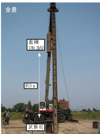
写真-6 急速荷重試験状況 Tset setup
