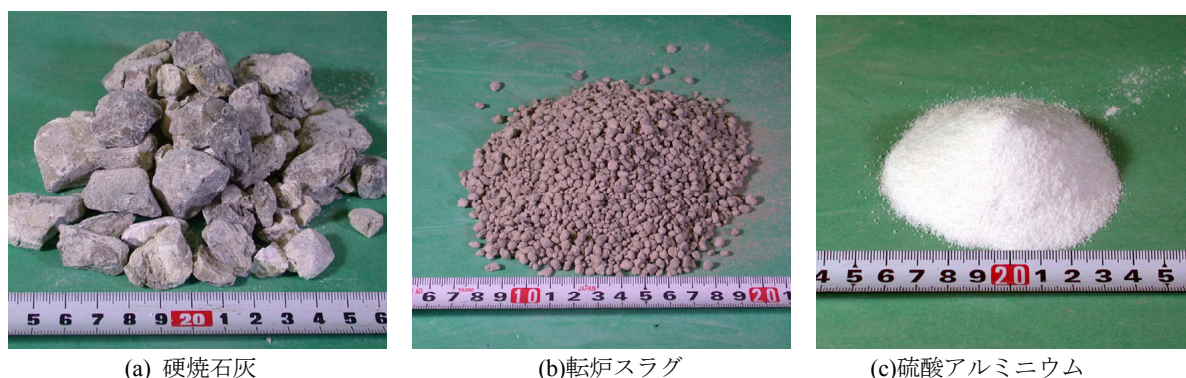
写真-2 「TAFDEX」の混合材料 Materials used for Producing ‘TAFDEX’
