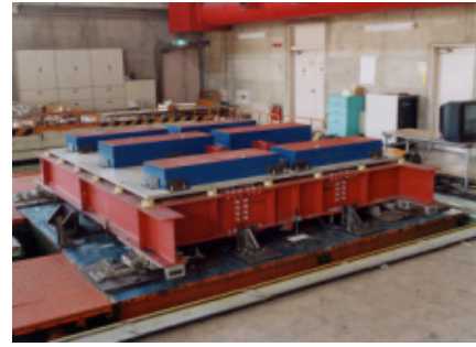
写真-1 床免震システムの外観 Floor isolation system
