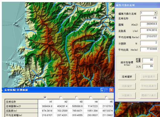
図-8 流域面積、平均流路幅の計算
