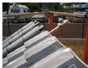
写真-6 日射計の設置状況
