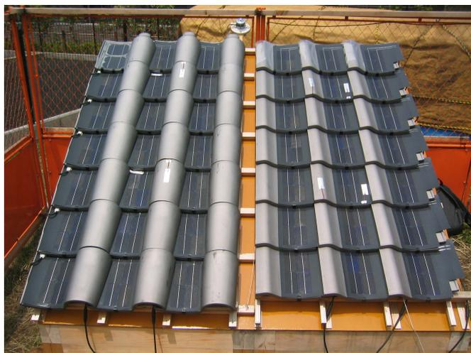
写真-5 製作した実大のシステム模型
