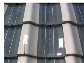
写真-7 温度センサー設置状況
