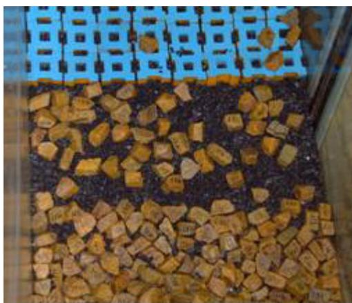
写真-1 上から撮影した小段部被覆石の移動状況
