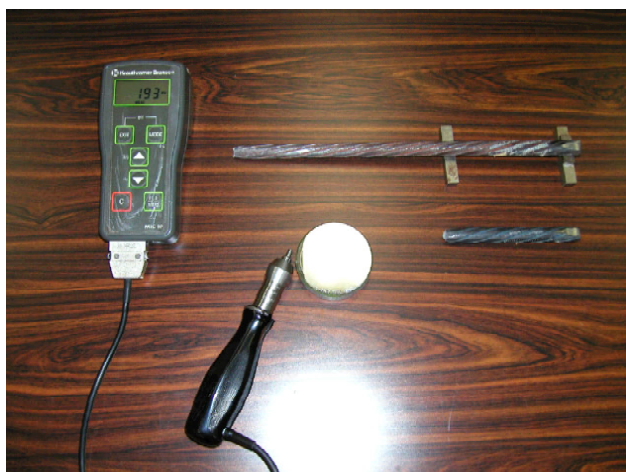
写真-1 超音波式簡易硬度計 Ultrasonic hardness tester
