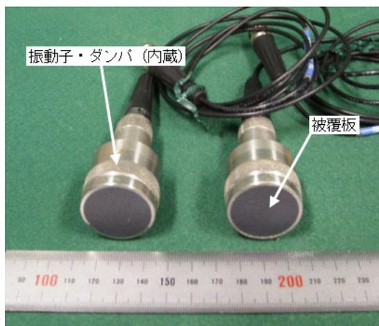
写真-1 本研究で用いた超音波探触子
