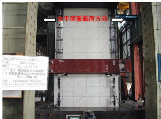
図-14  $\pm 1 \delta y = 8.8 \text{mm}$  時 (ひびわれ  $0.3 \sim 0.7 \text{mm}$ )
