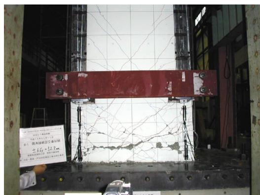
図-15  $\pm 6 \delta y = 52.8 \text{mm}$  時 (耐力が低下し始める)
