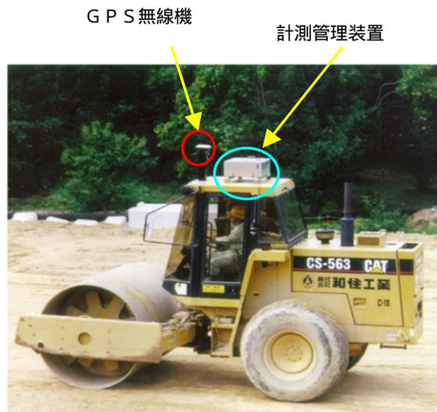
図-1 重機に設置したGPS無線機と計測管理装置
