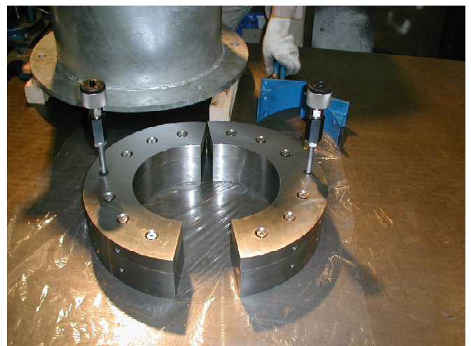
写真-2 10 MN 級シム型ロードセル 10 MN class shim-type load cell
