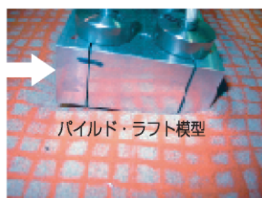
静的載荷試験後の地盤の変形状況
