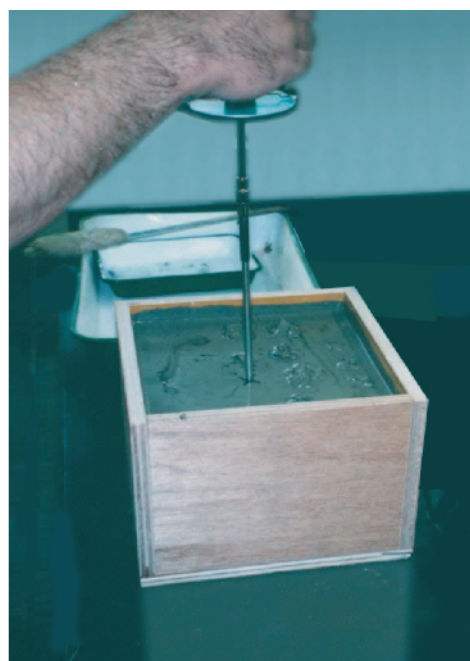
ハンドペーンせん断試験機による計測
