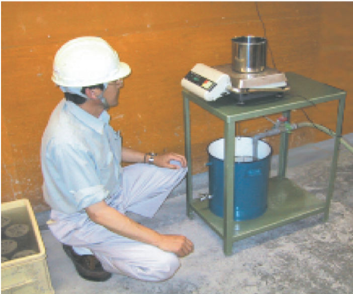
水中質量法による単位水量の測定
