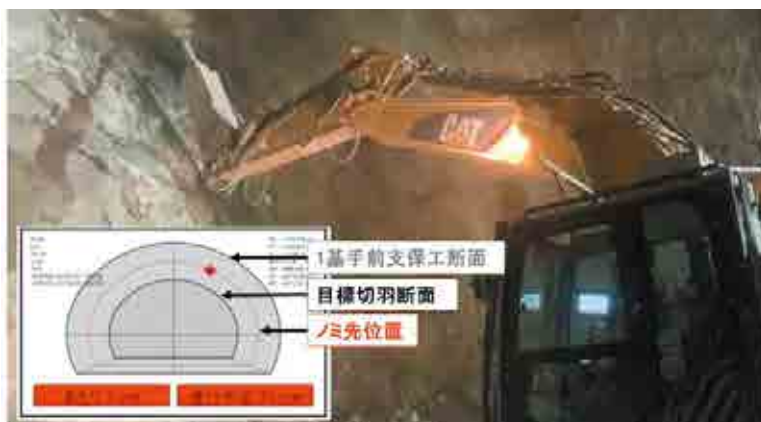
切羽アタリガイダンスシステム T-アタリパーフェクター
