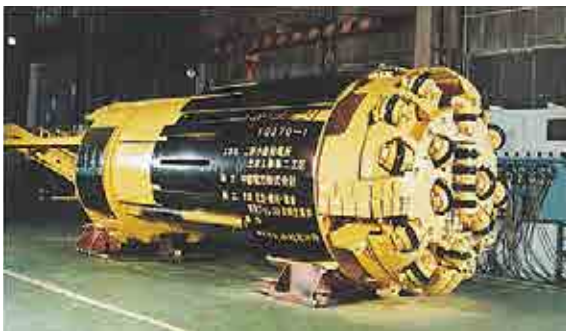
二軒小屋発電所の導水路トンネル掘削に威力を発揮した TBM
