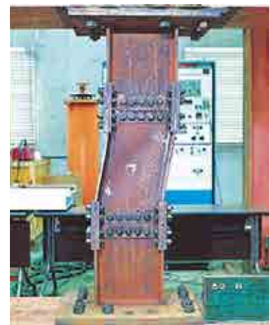
制振システム LOYAL の衝撃吸収用の柱
