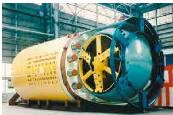
観音川雨水滞水池導水渠の工事で使われた球体シールド
