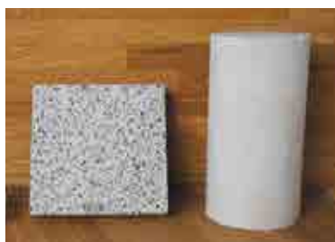
T-eConcrete/Carbon-Recycleの試験体(右)と石材調建材加工例(左)
