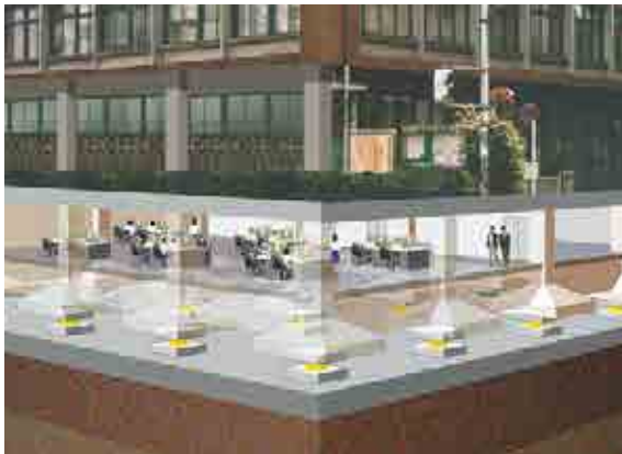
免震レトロフィットの仕組み（豊島区役所パース図）
