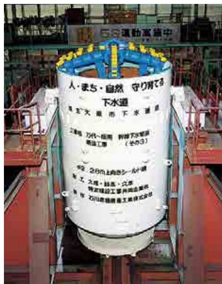
万代～阪南幹線下水管渠で使用された上向きシールド機
