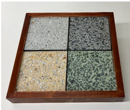
写真2 環境配慮コンクリート「T-eConcrete®」を用いた石材調建材
