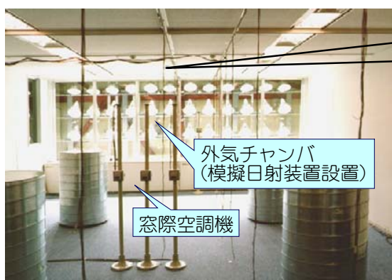
オフィス空間を模擬した実物大の実験室
