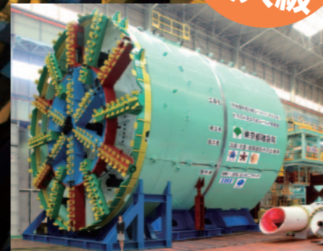
8kmにもわたる全工程を、1台のマシンで掘り進むという、世界でも例を見ない工事を可能にしたのが、日本最大級・最速のシールドマシンです。その重量は2500tとジャンボジェット機10機分もの大きさです。
