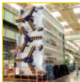
首都高川縦線トンネル工事 (神奈川県川崎市) *写真は縦型シールドマシン。
