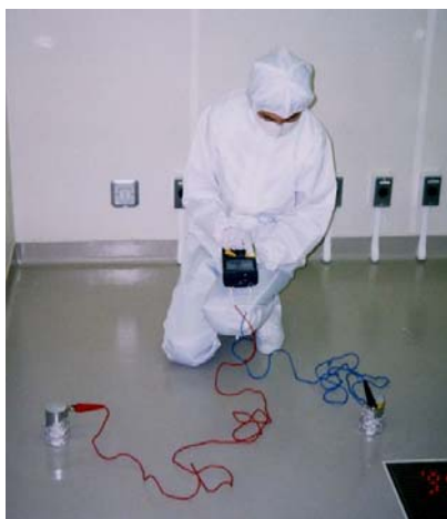
■床・内装材の電気抵抗測定
