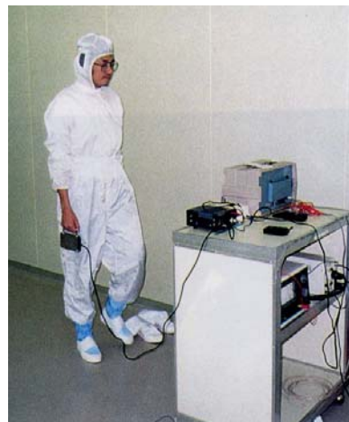
■作業者の帯電電圧の測定
